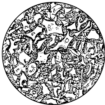
图 5—10 流纹质玻屑凝灰岩 主要由弧面棱角状玻屑组成，河北 宣化白垩系，单偏光×50
