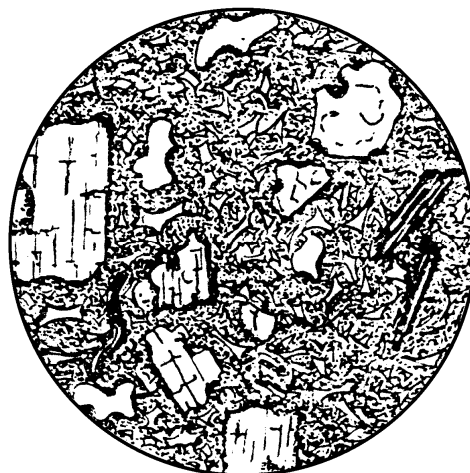
5-11 流纹质晶屑—玻屑凝灰岩， 晶屑为石英，长石及黑云母，见熔蚀现象 河北，张家口，白垩系，单偏光×50
