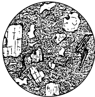
四 、 沉 火 图 5—12 多屑凝灰岩由岩屑、玻屑三种 物态组成的流纹质熔岩，河北下花园白垩 系，单偏光×50
